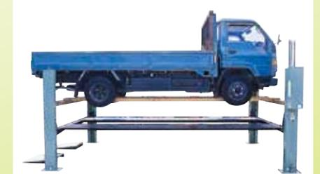
リフトアップしてランウェイを降下させればフリーホイール作業に早変わり。ホイール、ステアリング系統がフリーになるため、足回りの点検・整備、ブレーキ関係の整備に最適です。
