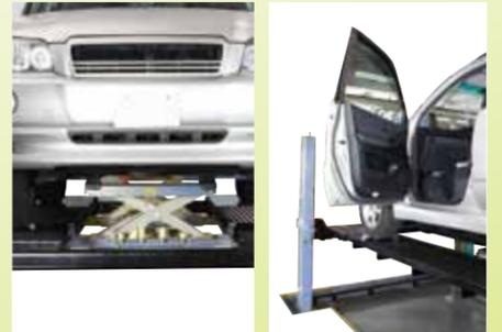
■ピットリフトにより安定したフリーホイール状態が得られ効率的に補正作業ができます。ピットリフトは左右のランウェイ間を前後自由に移動でき、アームの伸縮が可能のため軽自動車から普通自動車まで車体にあわせてセッティングが容易です。
