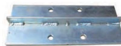
他社対応型の仕組みは右図のようにアタッチメントの底部に上記のような他社対応型ステーといったフランジ型の金具を取付けます。お手持ちの固定装置(ボディクランプ)でフランジをクランプする事により他社製固定装置で対応できます。
