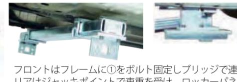
フロントはフレームに①をボルト固定しブリッジで連結。リアはジャッキポイントで車重を受け、ロッカーパネルを内側からクランプします。
