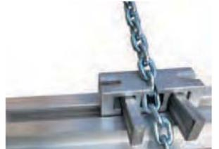
3方向へのチェーンロックが可能で、縦方向へのチェーンロックの場合、くさびを半叩き状態にし、ハンマーを使ってチェーンをピンと張る事ができます。
