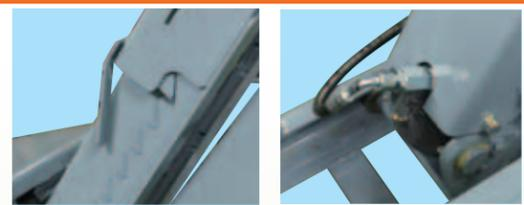
確実な作動の機械式ロック機構と、万一の油圧装置の故障にも降下を防止するヒューズバルブを採用。
