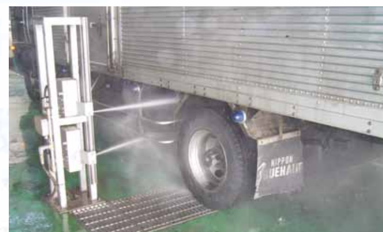
▲サイド洗浄ユニットで車輪の側面も洗浄 (オプション)
