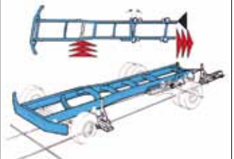
対角的な変位(変曲り)
