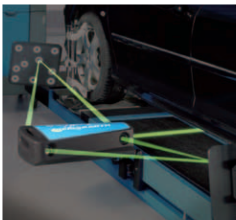
ターゲットの形状の変化で角度を検出
