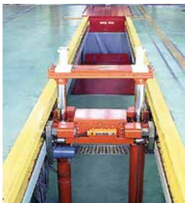
車両支持が2点のため安定してリフトアップできます。電動油圧昇降、電動走行のリモコン操作、特に低床バスの整備に最適です。
