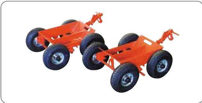
AT車や車輪のロックされた車のけん引に威力を発揮します。後輪の舵が効く新設計、タイヤ固定プレート採用。
